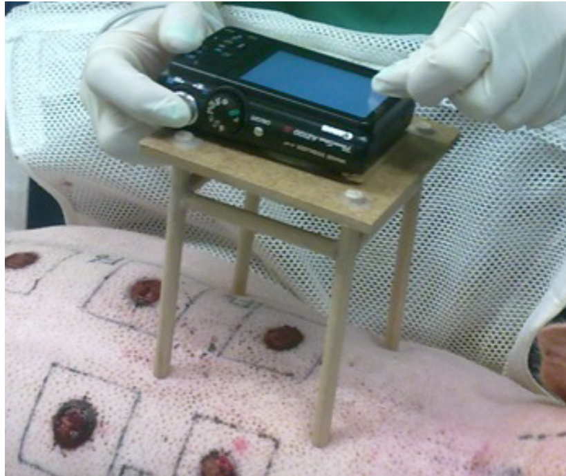
Abbildung 15: Stativ für die standardisierte Fotodokumentation
