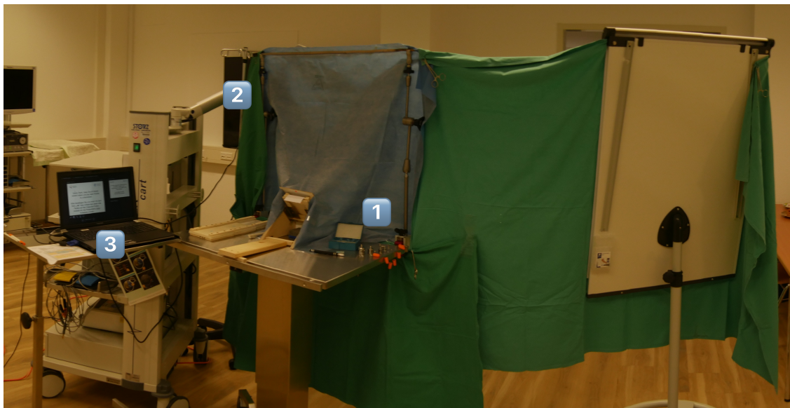
Abb. 2-10: Panorama des Versuchsaufbaus 1) Versuchsleiterplatz zur Änderung der Modalitäten 2) Laparoskopiebildschirm für die Proband*innen 3) Videoausgabegerät für den Versuchsleiter
