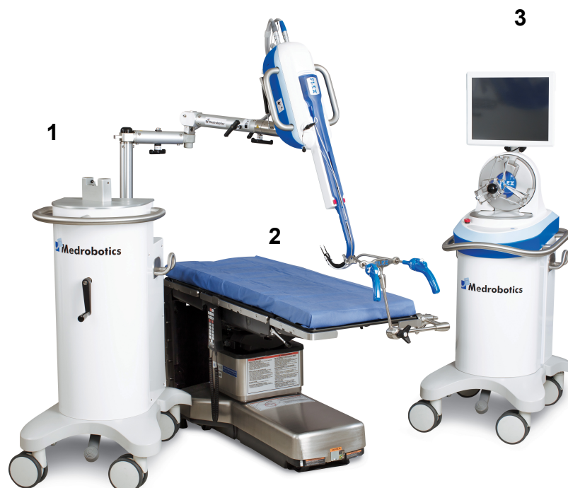
Abb.: 1-2: FLEX-Robotic-System 1) Operationseinheit 2) gekoppelter Operationstisch 3) Mastereinheit
