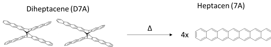
Abbildung 24: Synthese von Heptacene (7A) durch thermische Cycloreversion von Diheptacenen (D7A) nach Ref. (20)
